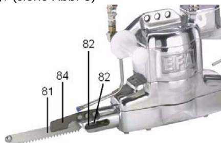
Abbildung 3: Lösen des Sägeblattes
