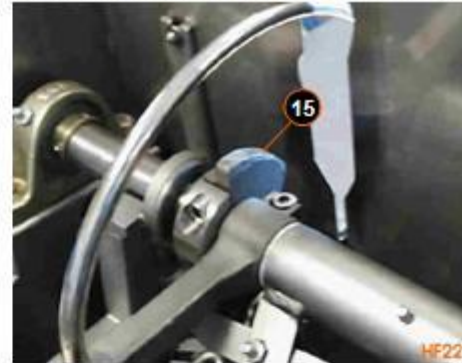
Wöchentlich zu schmierende Schmierstellen (Pinsel)
