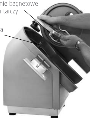
Rys. 11 Mocowanie tarczy na wałku
